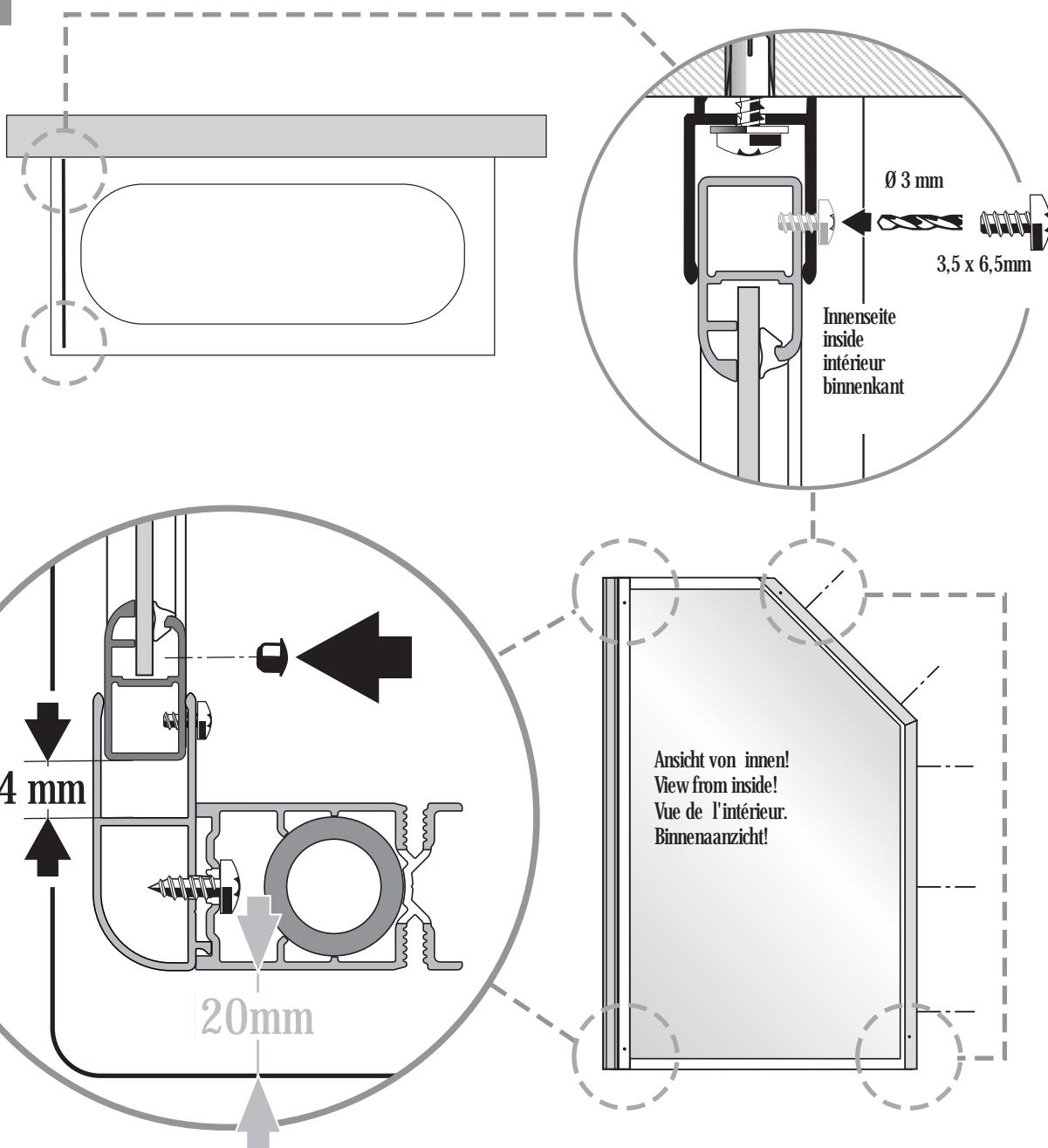
**DE** Reicht der Verstellbereich nicht aus - Eckprofil nach vorne versetzen (2 Bohrungen vorhanden).
