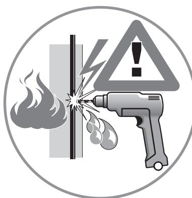
Achtung: Beachten Sie beim Bohren der Löcher, daß Sie keine Leitungen (Elektro, Gas, Wasser) beschädigen.
