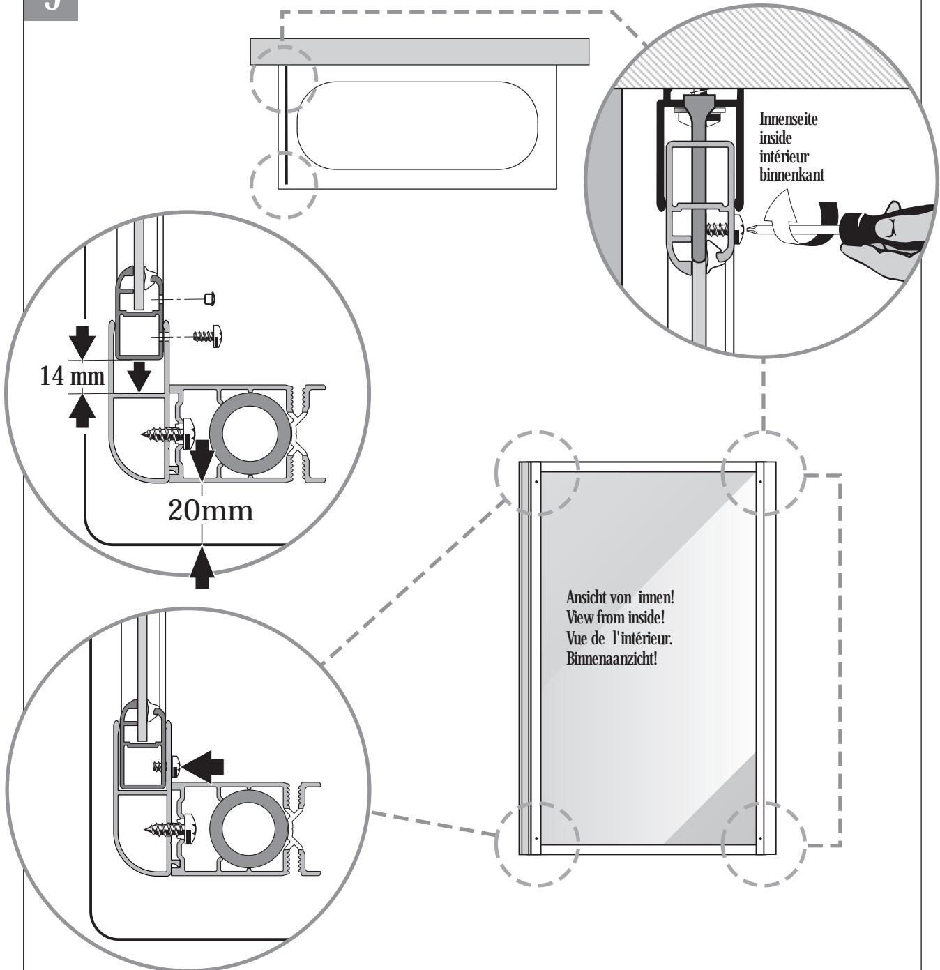
**DE** Reicht der Verstellbereich nicht aus - Eckprofil versetzen (2 Bohrungen vorhanden). Seitenwand mit Klemmschrauben fixieren.
