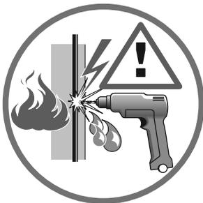
**DE** Achtung: Beachten Sie beim Bohren der Löcher, dass Sie keine Leitungen (Elektro, Gas, Wasser) beschädigen !
