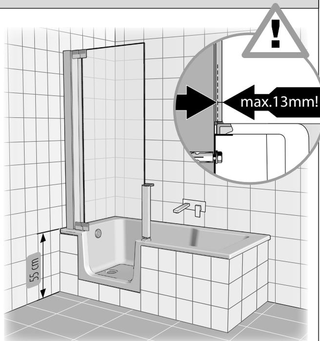
Le carrelage ne doit dépasser que de **maxi 13 mm** sur le bord de la baignoire. N'installer la baignoire que sur un sol complètement carrelé et terminé. Par contre les murs doivent rester nus.
