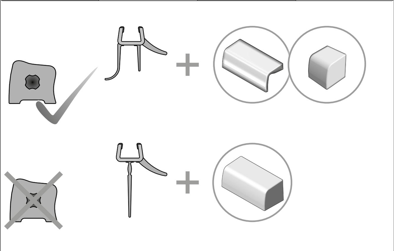
**DE** Der Hersteller weist an dieser Stelle ausdrücklich darauf hin, dass die Montage der im Lieferumfang enthaltenen Schwalleiste zur Erreichung der Dichtheitsanforderungen nach Norm (DIN 14428) erforderlich ist. Wird auf die Schwalleiste verzichtet, übernimmt der Hersteller keinerlei Haftung für daraus resultierende Schäden.
