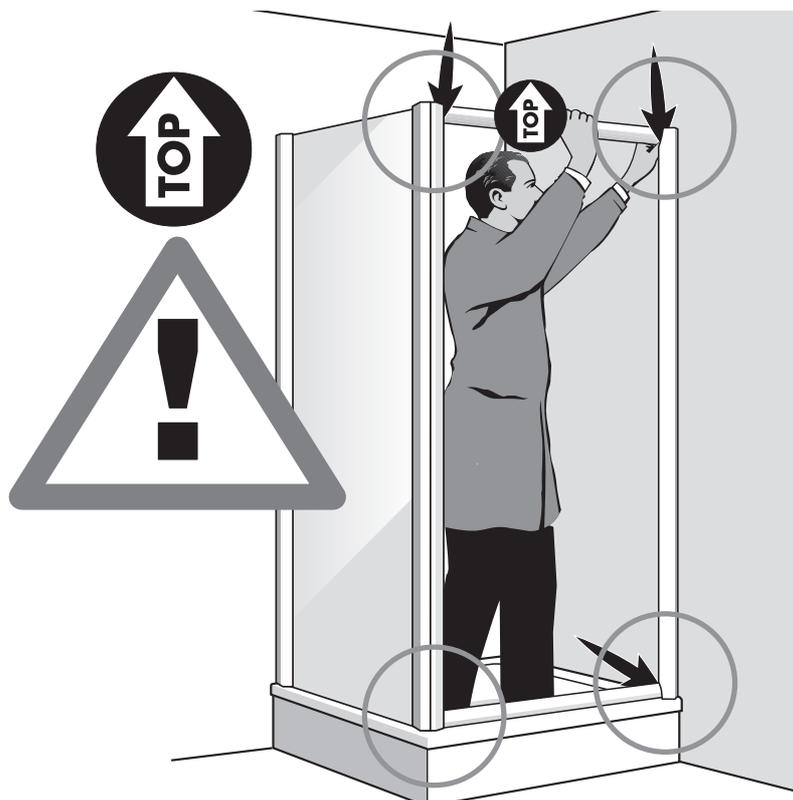
**DE** Querprofile unten und oben einsetzen. **WICHTIG!** Das obere Querprofil ist mit **TOP** gekennzeichnet. Siehe dazu die Details auf Seite 22/8 (Bild 11 und 12).
