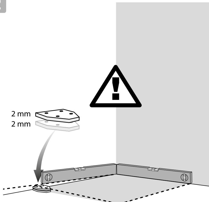
**DE** **ACHTUNG!** Eine **einwandfreie** Montage ist nur möglich wenn der Boden **waagrecht** und die Wände **senkrecht** sind. Bei Bedarf beiliegende **Unterlagsplättchen** verwenden!
