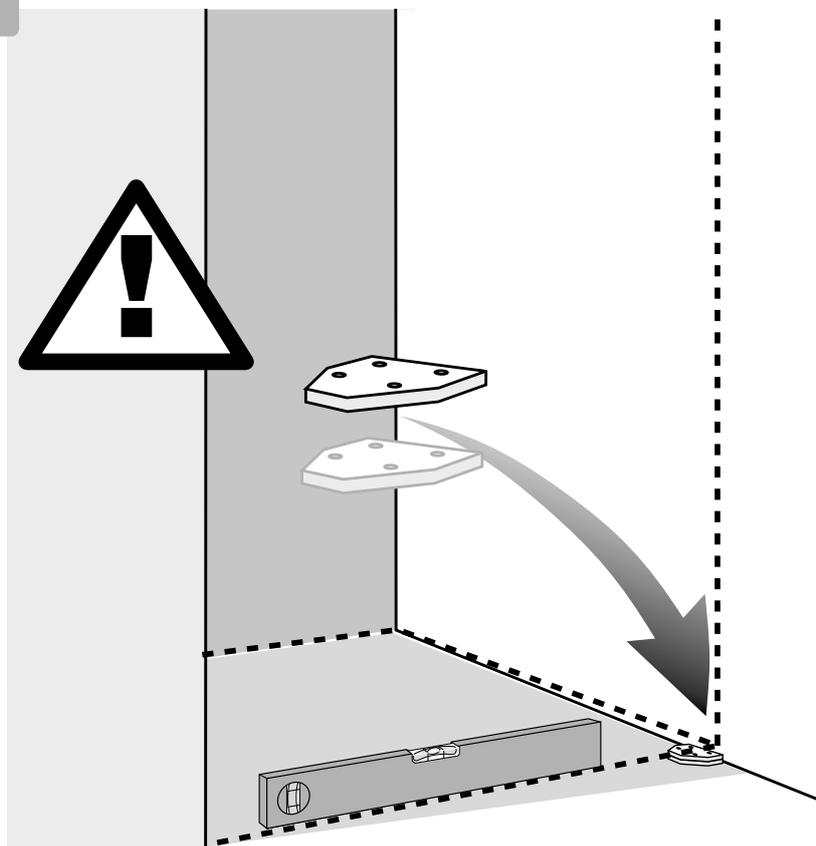
**DE ACHTUNG!** Eine **einwandfreie** Montage ist nur möglich wenn der Boden **waagrecht** und die Wände **senkrecht** sind. Bei Bedarf beiliegende **Unterlagsplättchen** verwenden!
