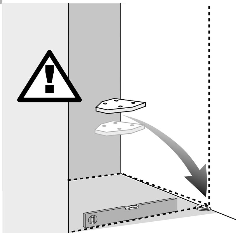
**DE ACHTUNG!** Eine **einwandfreie** Montage ist nur möglich wenn der Boden **waagrecht** und die Wände **senkrecht** sind. Bei Bedarf beiliegende **Unterlagsplättchen** verwenden!
