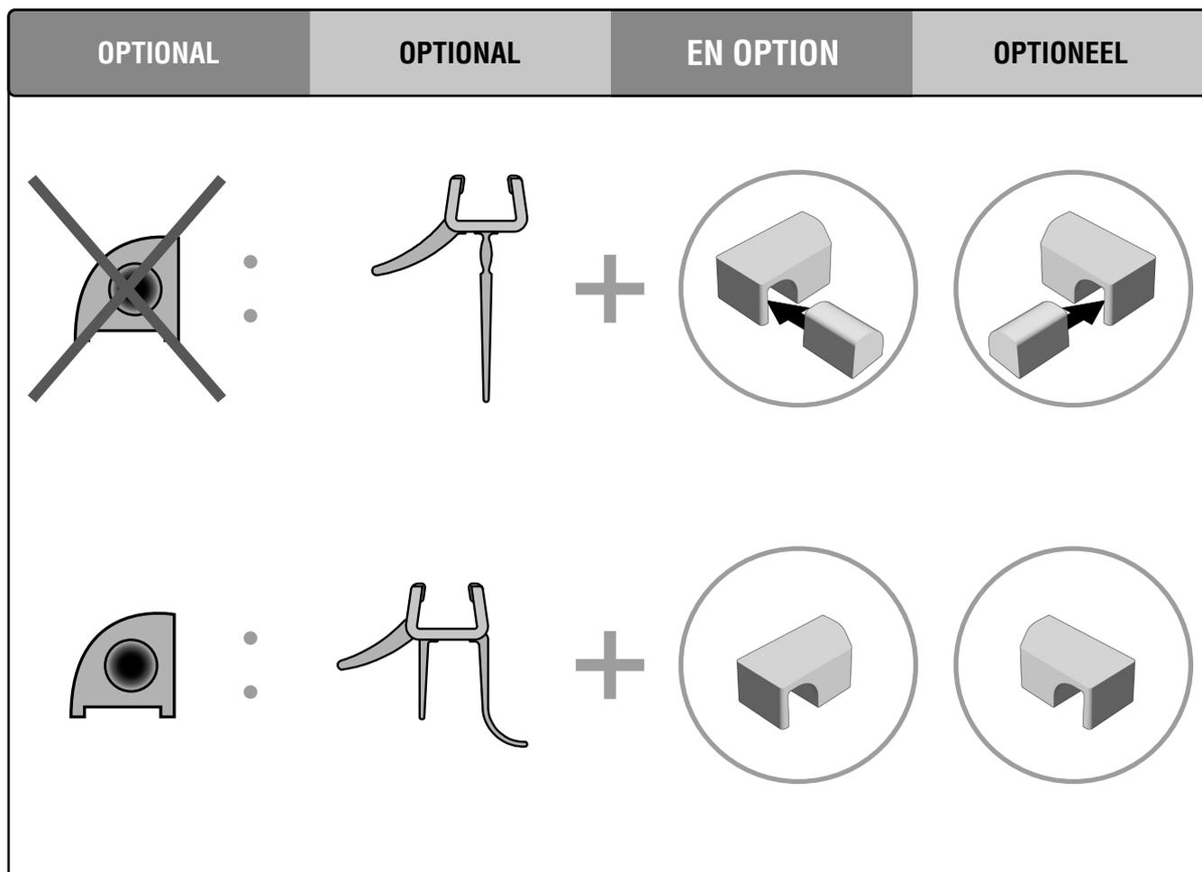
**DE** Der Hersteller weist an dieser Stelle ausdrücklich darauf hin, dass die Montage der im Lieferumfang enthaltenen Schwallleiste zur Erreichung der Dichtheitsanforderungen nach Norm (DIN 14428) erforderlich ist. Wird auf die Schwallleiste verzichtet, übernimmt der Hersteller keinerlei Haftung für daraus resultierende Schäden.
