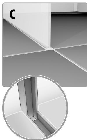
**DE** Glaselement im Boden mit Bodenprofil
