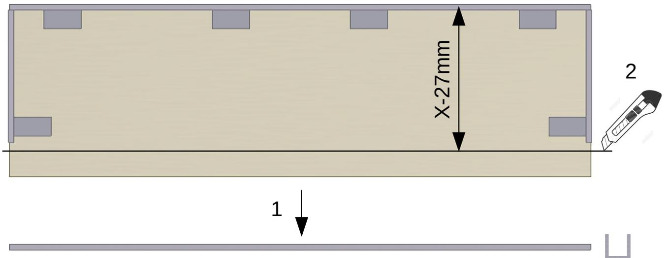
**Einbauvariante A1 ohne Stufe beim Einstieg**
