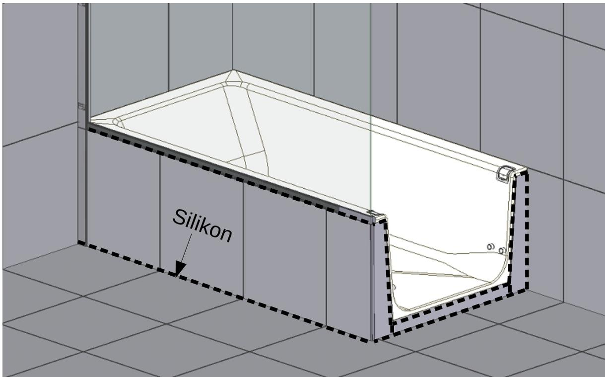
**Einbauvariante A1 ohne Stufe beim Einstieg**
