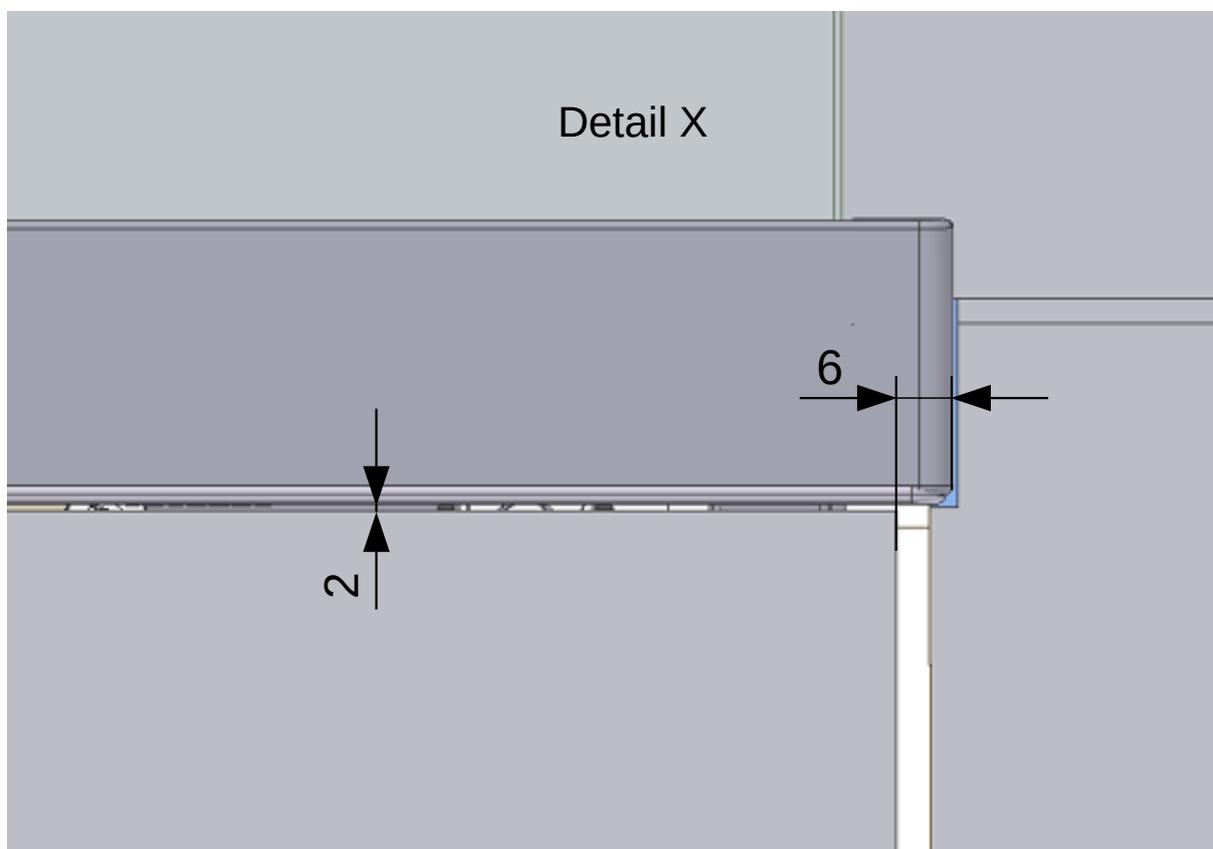
**Fliese Einbauvariante A2 und B mit Stufe 80mm und 165mm**
