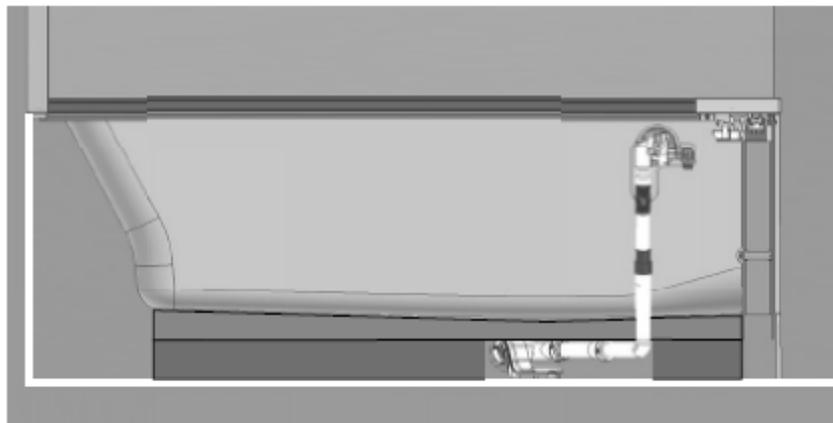
**Schürze Einbauvariante A2 mit Stufe 80mm**
