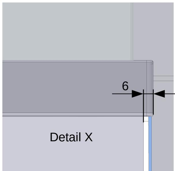
**Schürze Einbauvariante A2 mit Stufe 80mm**
