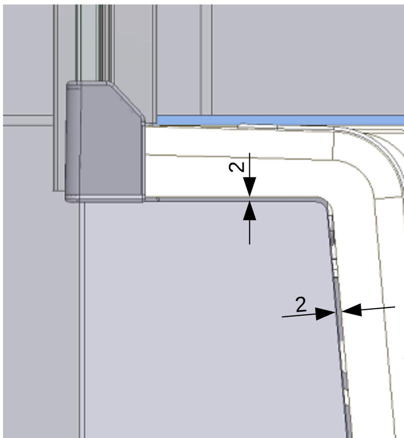
**Schürze Einbauvariante B mit Stufe 165mm**
