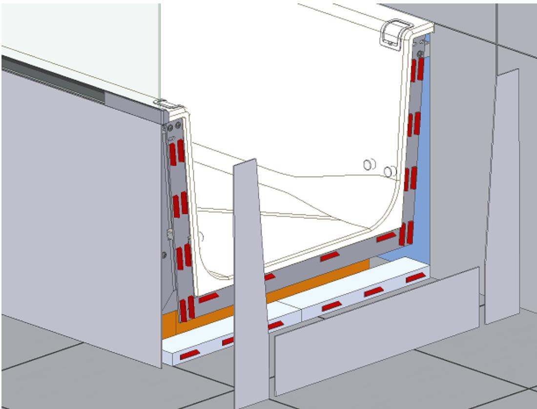
**Schürze Einbauvariante B mit Stufe 165mm**
