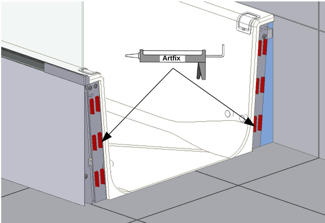
**Einbauvariante A1 ohne Stufe beim Einstieg**
