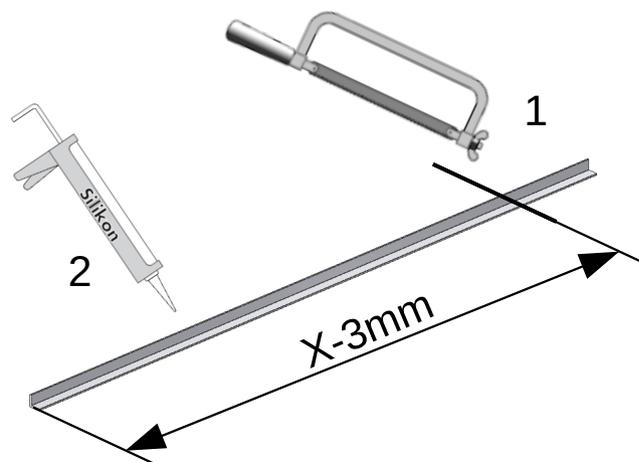
**Schürze Einbauvariante A2 und B mit Stufe 80mm und 165mm**
