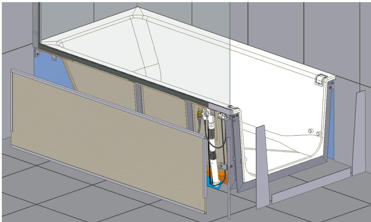
**Fliese Einbauvariante A2 und B mit Stufe 80mm und 165mm**
