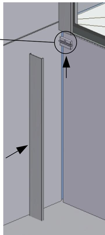
**Schürze Einbauvariante A2 und B mit Stufe 80mm und 165mm**
