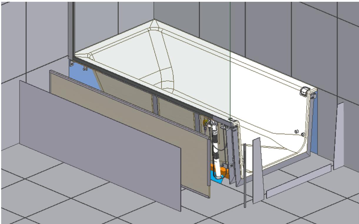
**Schürze Einbauvariante A2 mit Stufe 80mm**
