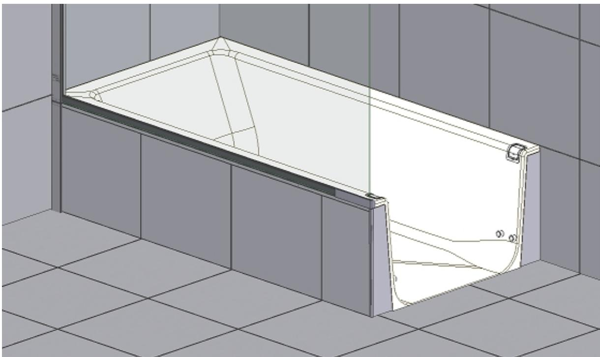
**Einbauvariante A1 ohne Stufe beim Einstieg**
