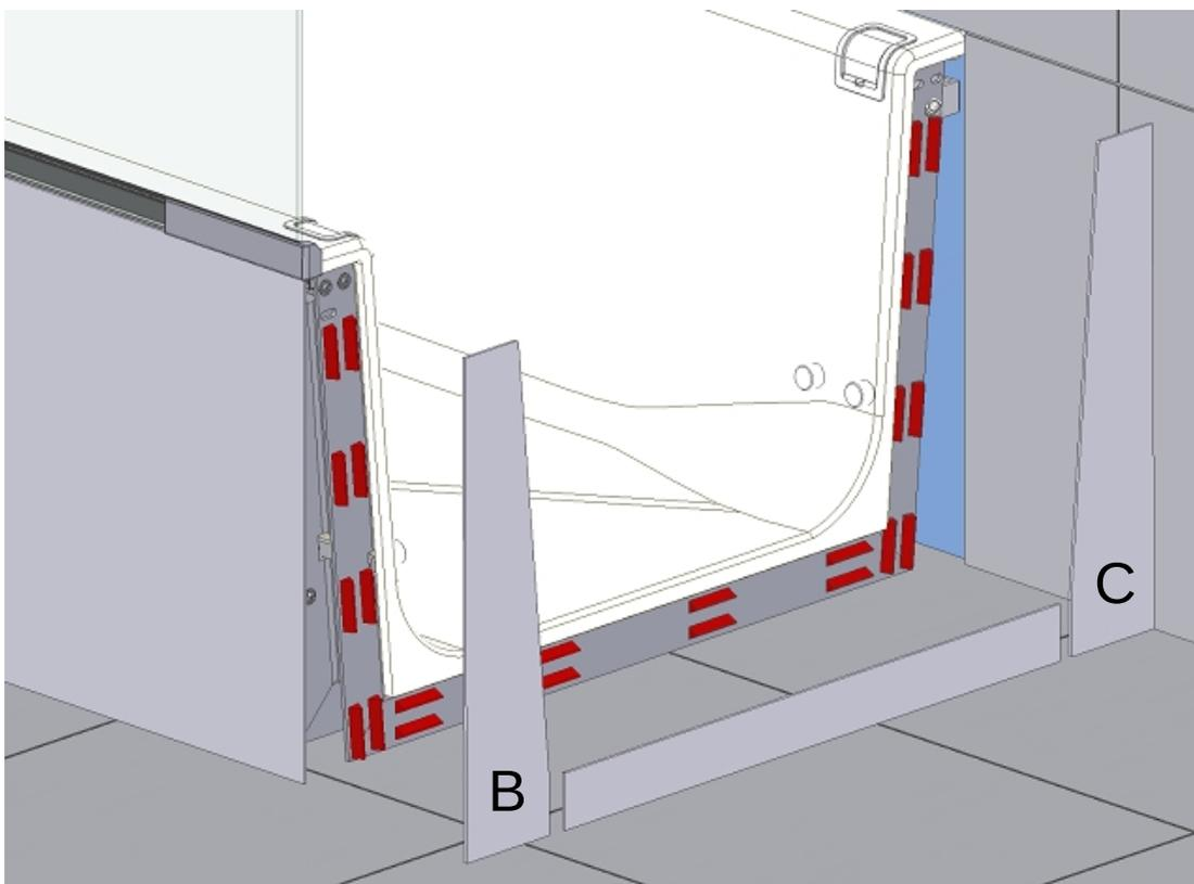
**Schürze Einbauvariante A2 mit Stufe 80mm**
