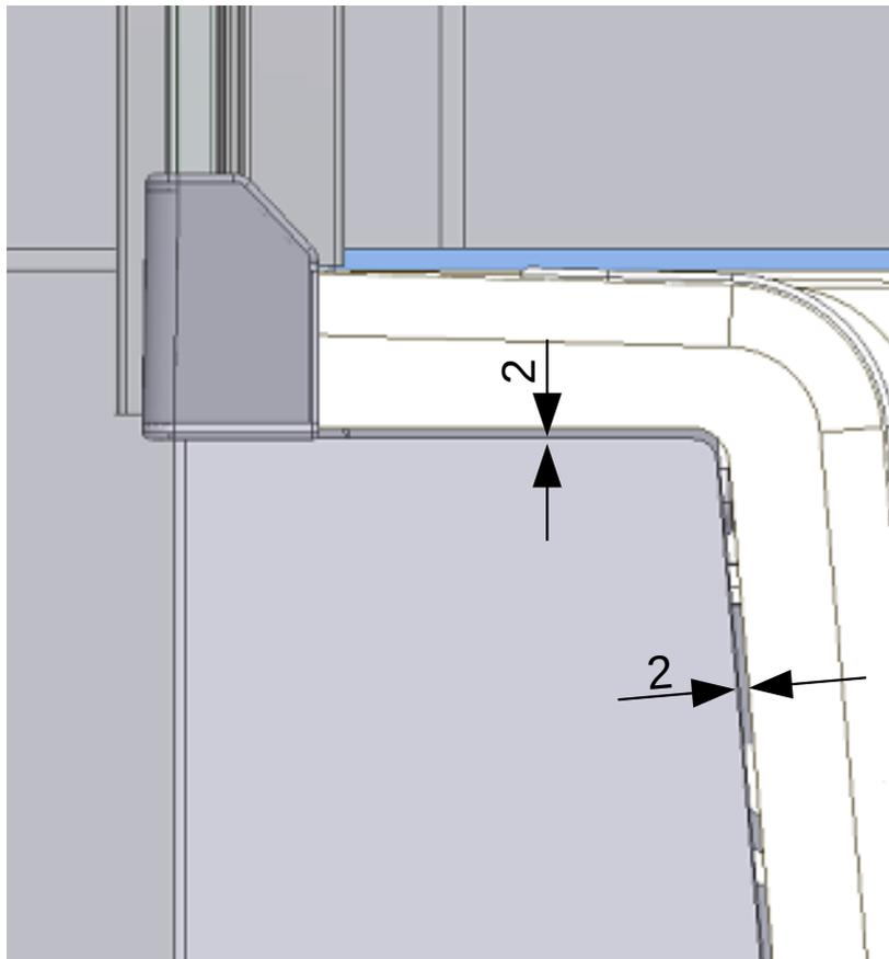
**Schürze Einbauvariante A2 und B mit Stufe 80mm und 165mm**
